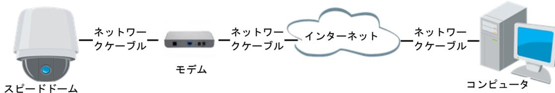
図 1-12 動的 IP を持つカメラによるアクセス
