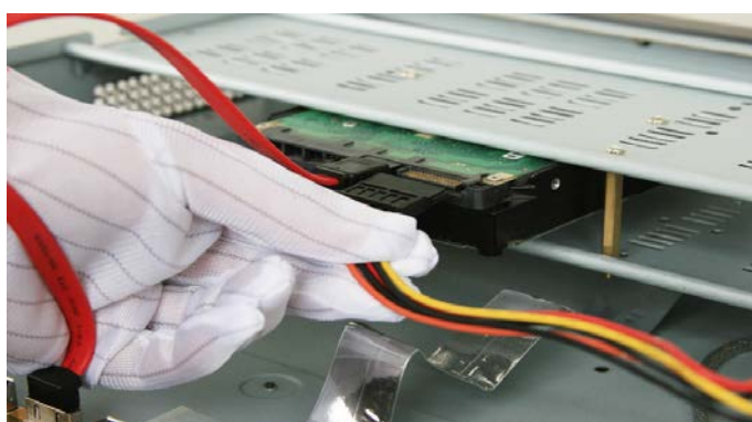
図 2.4 電源ケーブルの接続
