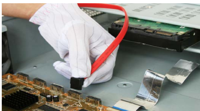
図 2.3 データケーブルの接続
