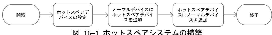
図 16-1 ホットスペアシステムの構築
