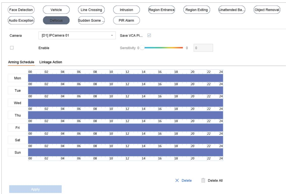
図 12-11 ピンぼけ検知
