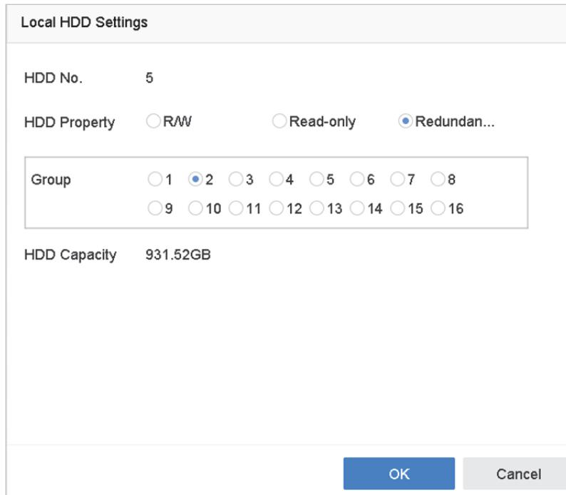
図 7-14 HDD プロパティ – 冗長
