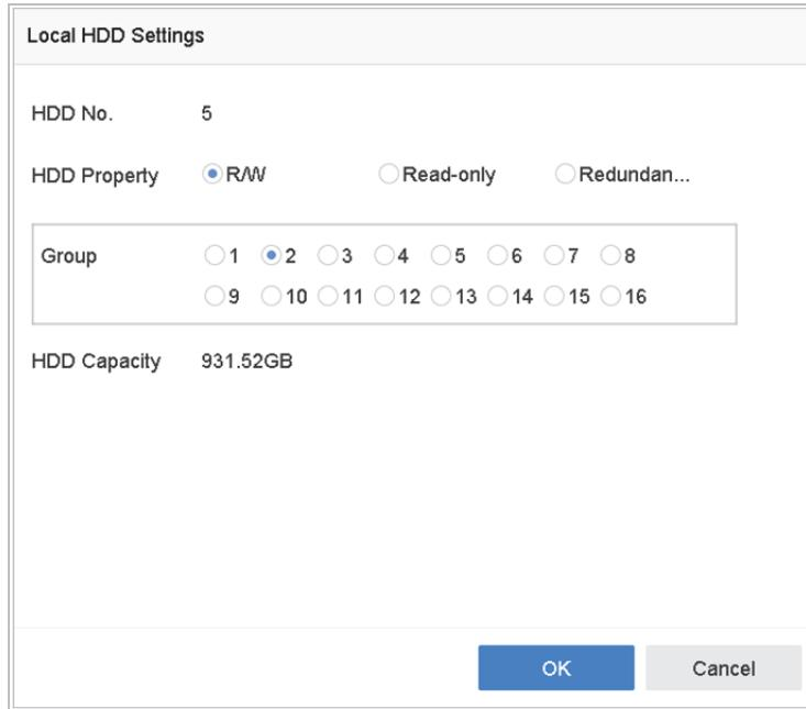
図 7-5 ローカル HDD の設定
