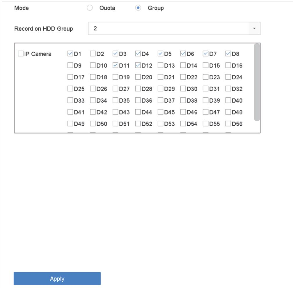
図 7-6 ストレージモード – HDD グループ
