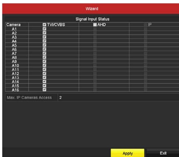
図3.9 信号入力タイプを設定します (DS-7200HUHI-F/N)
