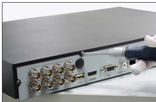
図2.1 カバーを取り外します
