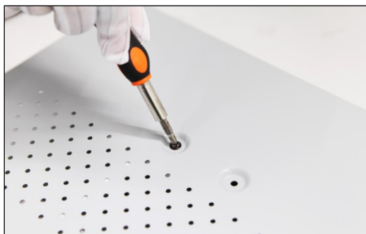
図2.4 HDD を取り付けます
