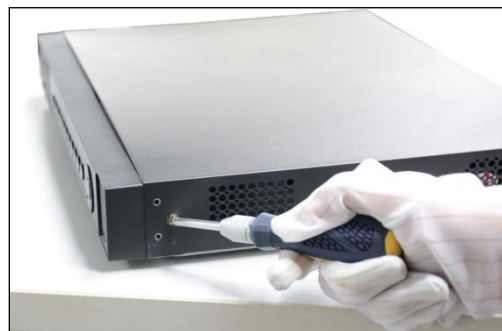
図2.1 カバーを取り外します
