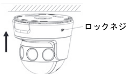
図 2-8 カメラのアダプタープレートへの固定
