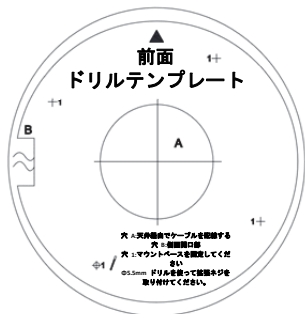
図 2-4 天井のドリル孔
