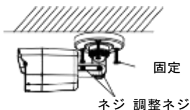
図 2-2 カメラを天井に固定する
