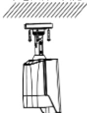
図 2-9カメラを天井に固定する
